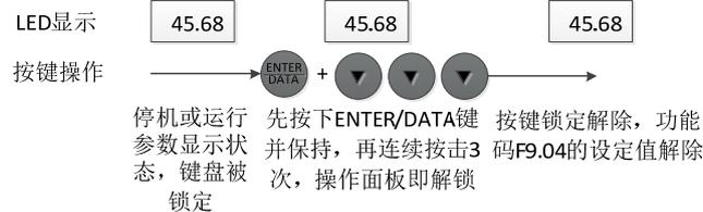
图4-13 操作面板按键解锁操作示例
