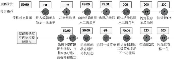
图4-12 操作面板按键锁定操作示例
